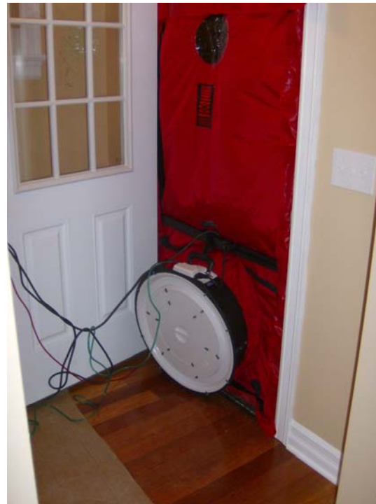
Blower Door Setup
